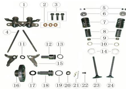
FIG.2.BALANCINES ARBOL DE LEVAS VALVULAS
