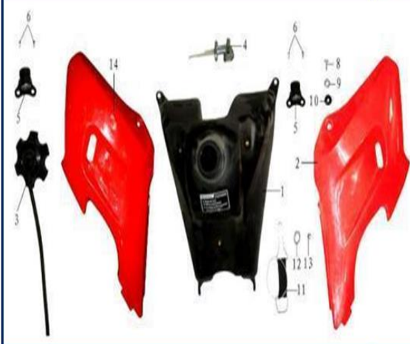
Figura N° 22: Tanque de gasolina PAG N° 25
